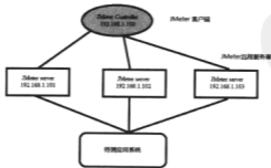
图 11-3 JMeter 远程测试原理图
