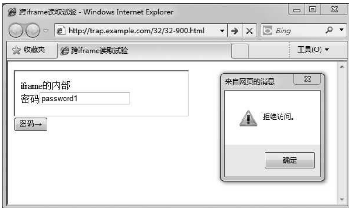
图 3-29 XSS 通过将 JavaScript 放到内层从而在同源的环境下执行
