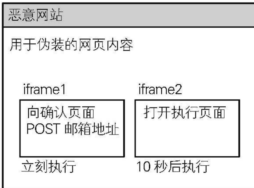
图 4-48 使用 2 个 iframe 元素的两个阶段的攻击
