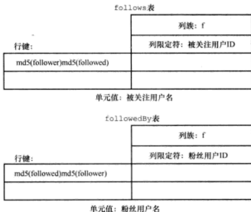
图 5-4 优化了存储空间和 IO 效率的 follows 和 followedBy 表的模式。follows 表存储了根据关注关系建立索引的一半关系实体，followedBy 表存储了根据被关注关系建立索引的另一半关系实体
