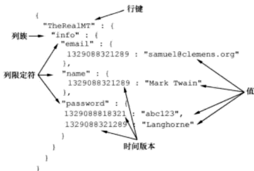
图 2-7 有序映射的映射。HBase 逻辑上把数据组织成嵌套的映射的映射。每层映射集合里，数据按照映射集合的键字典序排序。本例中，“email”排在“name”前面，最新时间版本排在稍晚时间版本前面。
