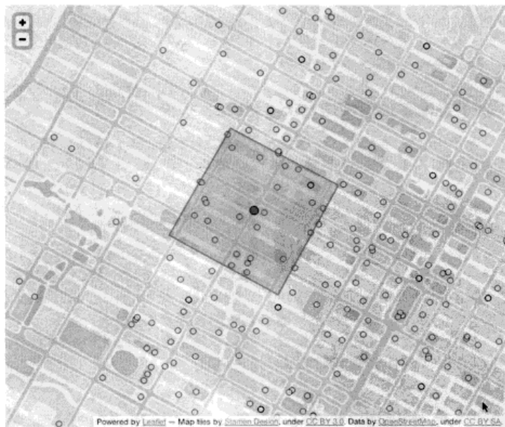
图 8-12 带有形心的查询多边形。形心点是你开始计算最小边界的 geohash 集合的地方
