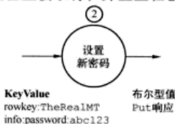
图 6-8 第 2 步根据旧密码生成一个新密码，然后发送一个 Put 给 HBase
