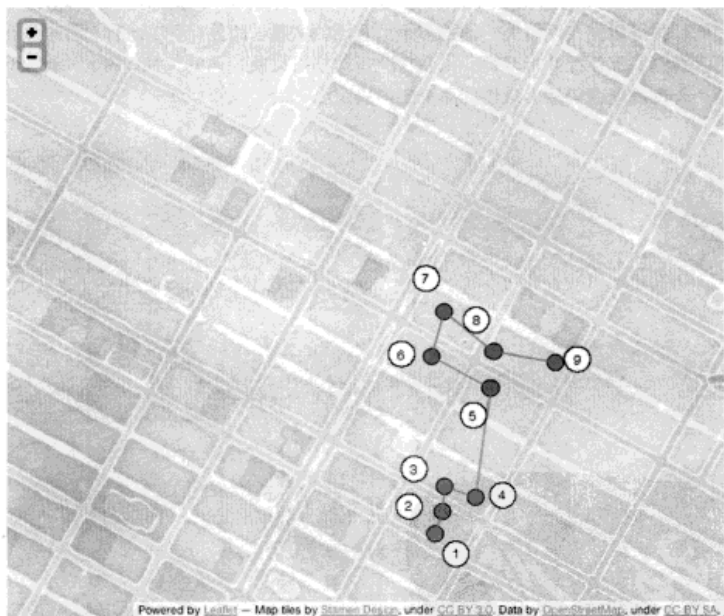
图 8-7 观察实战中前缀的匹配情况。如果目标搜索在这个区域，一个简单的行键扫描就可以得到你需要的数据。不仅如此，返回结果的顺序比图 8-3 所示的顺序更合理
