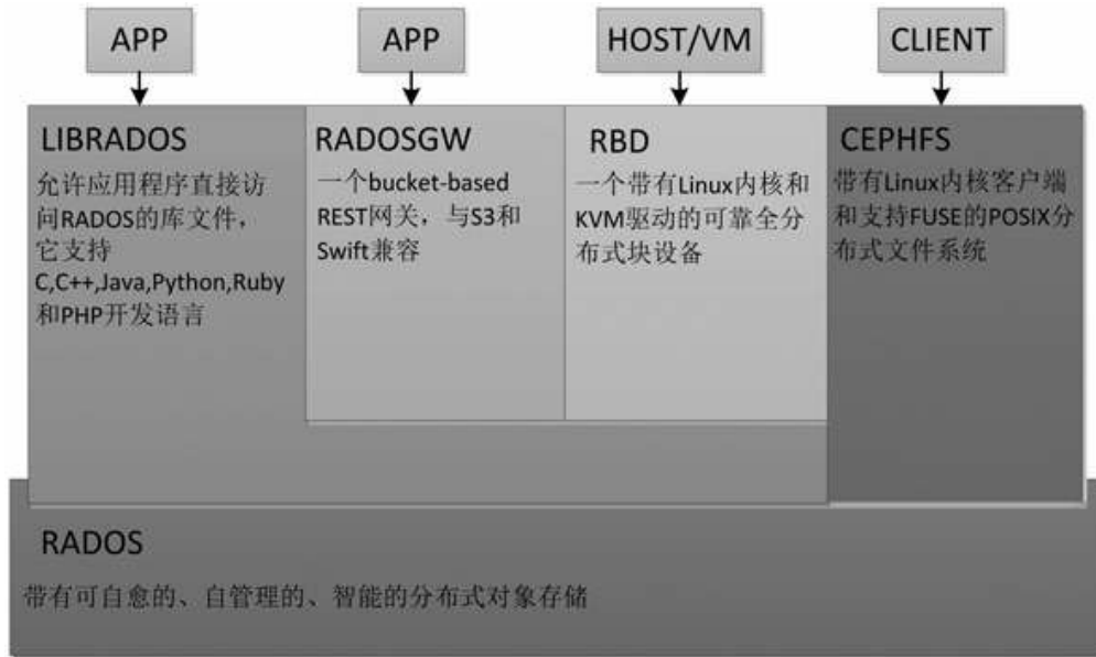
图9.11 Ceph存储组件关系图
