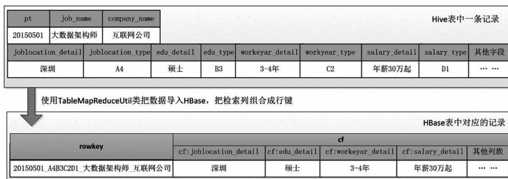
图6.5 Hive到HBase数据存储示意图
