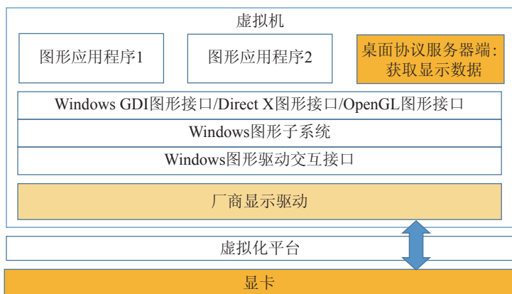
图11-11 GPU直通实现原理
