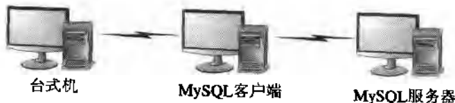
图1.3 在这种情况下，你的终端可以是有能力相互连接的任何一台机器，它甚至不运行MySQL客户端
