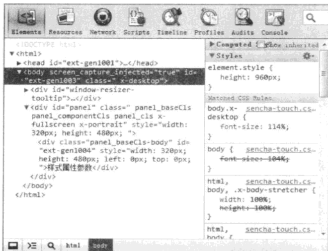
图 9-14 被重置 baseCls 样式的 Panel 组件源代码
