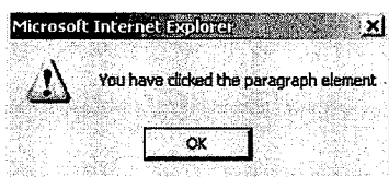
图 3-44 由于事件冒泡而执行段落元素的事件处理函数，显示警报消息
