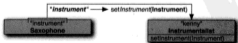
图 3.1 使用 byName 自动装配时，Bean 的名字会与有相同名字的属性相匹配
