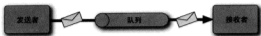
图 12.3 消息队列对消息发送者和消息接收者进行了解耦。虽然队列可以有多个接收者，但是每条消息只能被一个接收者取走
