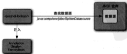
图 14.3 <jee:jndi-lookup> 查找位于 JNDI 中的对象，使其可以在 Spring 应用上下文中以 Bean 的形式使用。这样，它就能够注入到任何依赖它的对象中
