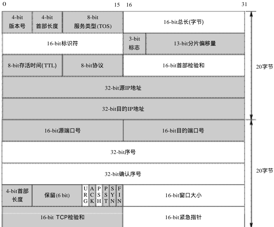
图29-33 组合的IP和TCP首部：阴影字段通常不变化
