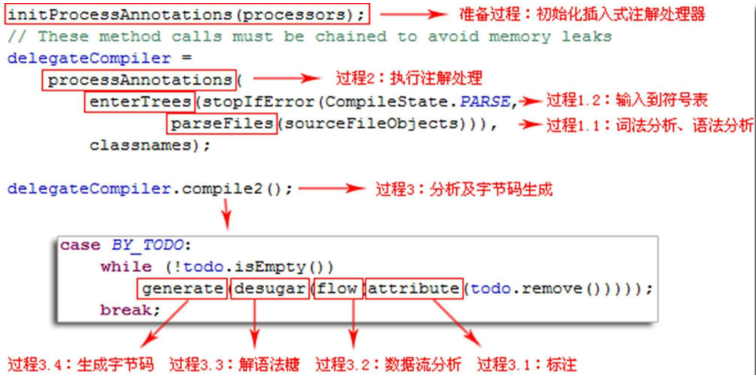
图10-5 Javac编译过程的主体代码
